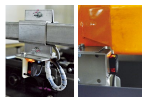
荷物検出センサ 荷物の入出庫及びレーンの満杯状態を検出します。
