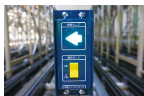
スイッチボックス 自動・手動操作を切り替えるスイッチです。LEDランプで機器の状態を表示します。
