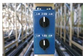
操作モードスイッチ 自動操作に切り替えた場合に各段の入庫・出庫モードを切り替えるスイッチです。
