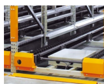
フォークリフトストッパー フォークリフトとラックとの接触を防止するためのストッパーです。
