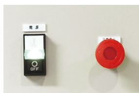
非常停止スイッチ 荷物の搬送時、異常事態が発生した際、制御盤への電源供給を遮断します。
