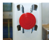
間口用非常停止スイッチ 荷物の搬送時に異常事態が発生した際、モータを非常停止させるスイッチです。
