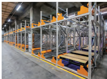
倉庫中央の柱間に 3 間口のラックを 5 基設置し、大量保管を実現。スペースコントロールにより入出庫用の動線が確保できたことで、お客様のご希望である「先入れ先出し」の運用が可能になりました。
