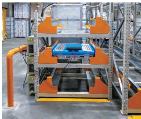
作業の停滞を防ぐため、ラックの隣には充電ステーションを設置。電源の消耗が激しい冷凍環境下での運用をカバーしています。
