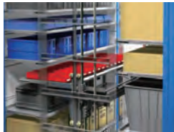
③リフトで上下し、前後のレールに荷物を収納
