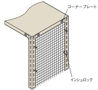
**3 支柱と棚板の間に側板を入れ仮締めします。**
