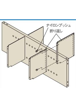
仕切板で棚板を挟み込み、天側から順にナイロンプッシュで固定します。その際、折り返し部が手前で、仕切られた間口寸法が均等になるように仕切板の方向を揃えてください。
