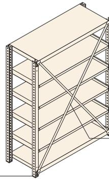
背面ブレースの取付けにより、危険物保管と同程度の強度を実現!
