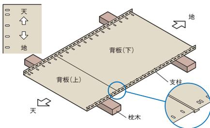
**2** 棚板をセットし、背板側を仮締めします。
