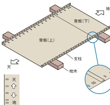
**2** 仕切板をセットしながら支柱に棚板を仮止めします。
