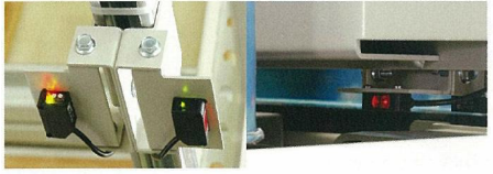
荷物検出センサ 荷物の出入庫及びレーンの満杯状態を検出します。
