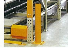
安全ボール フォークリフトとラックとの接触を防止するためのボールです。
