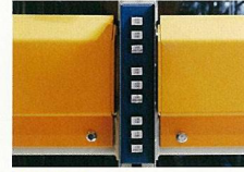
切り替えスイッチ 入出庫方法を切り換える際、使用します。
