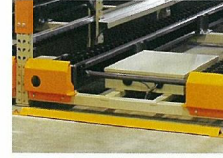
フォークリフトストッパー フォークリフトとラックとの接触を防止するためのストッパーです。
