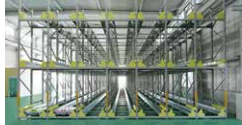
出荷前の商品を種類別に各レーンでロット保管。 省スペースながら420パレットの保管を実現。
